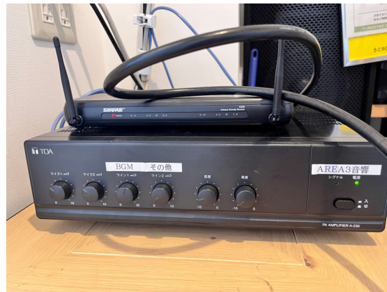
種別：オーディオ 個数：1 詳細：PA AMPLIFIER A-230 / ジャック接続
